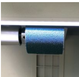
LED-Beleuchtung im Schleifbandbereich
